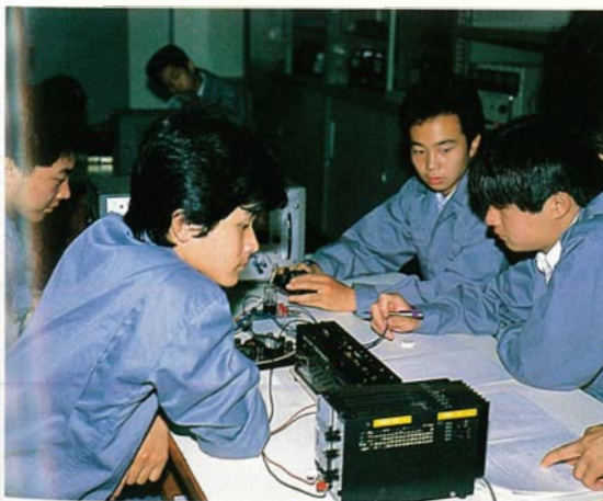
電子工学実習(3極真空管の静特性の測定)
