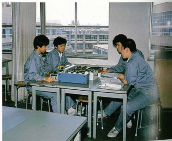
電気計測実習(ケルビン法による検流計の内部抵抗)
