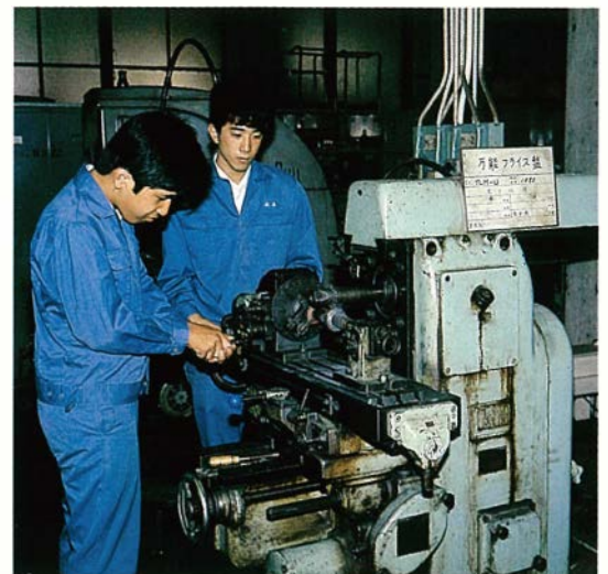
特機実習(フライス盤の歯みぞ切削加工)
