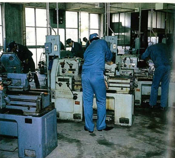
旋盤応用実習(豆ジャッキの製作)
